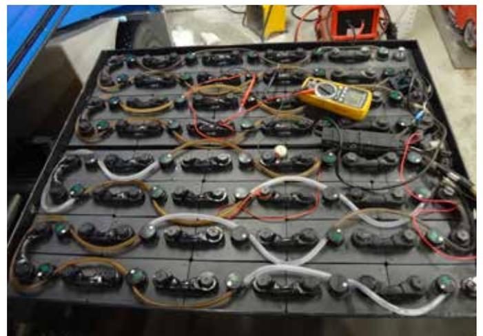
Zwei Tonnen schwere Batterie von der Eismaschine, während der Zwischensaison werden alle Batteriezellen überprüft. (Quelle: Iris Infanger)
