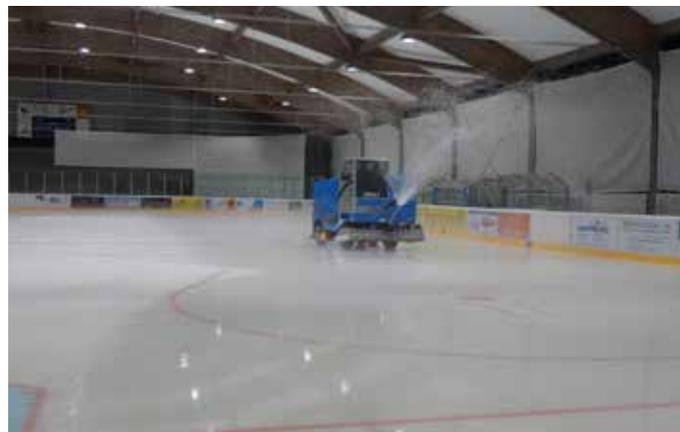
Ab zwei Zentimeter, wenn das Eis genug dick ist und die Markierungen und das Kreidenmehl nicht mehr kaputt gehen können, wird das Wasser mit der sechs bis sieben Tonnen schweren Eismaschine bewässert. (Quelle: Iris Infanger)
