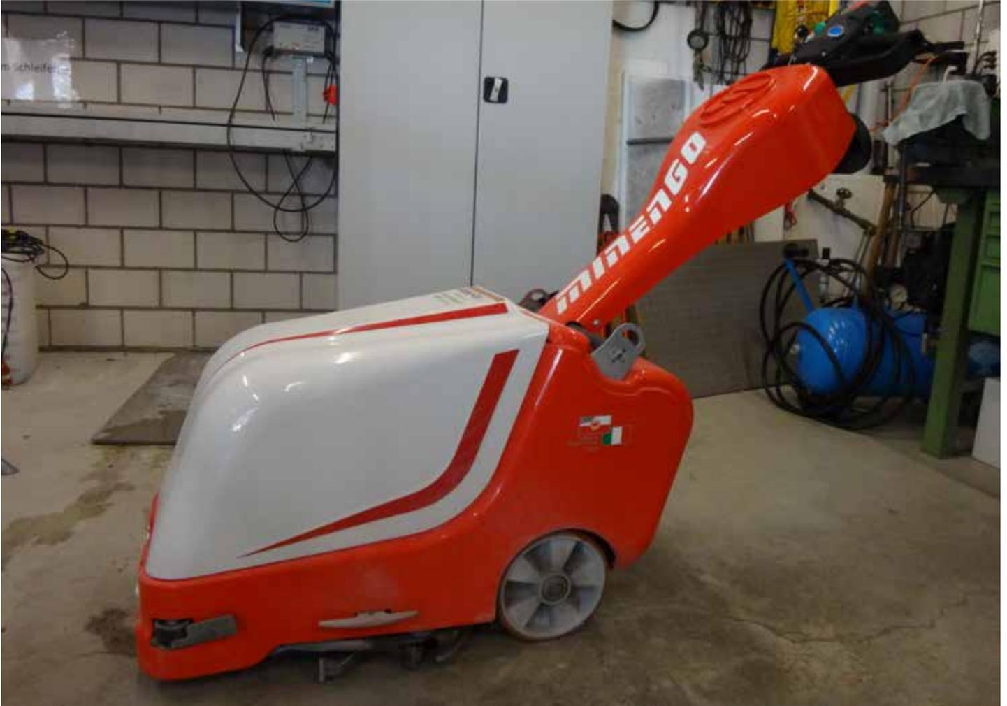
Der kleine Bandenfräser «Minengo». Damit werden Wasserläufe entlang der Banden weggemacht. (Quelle: Iris Infanger)
