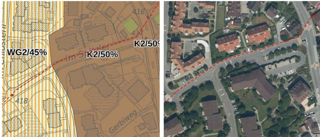
Abbildung 45: Darstellung des Abschnittes Obe-03 mit dem Verlauf der Eindolung rot eingezeichnet auf dem Zonenplan des ÖREB-Katasters (links, grün eingetragene sind die kommunalen Denkmalschutzobjekte) und Orthofoto (rechts).
