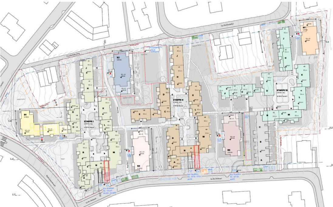
Abb. 9 Situationsplan mit Etappen (Aufstockung) und Bereichen (Neubau) [1]
