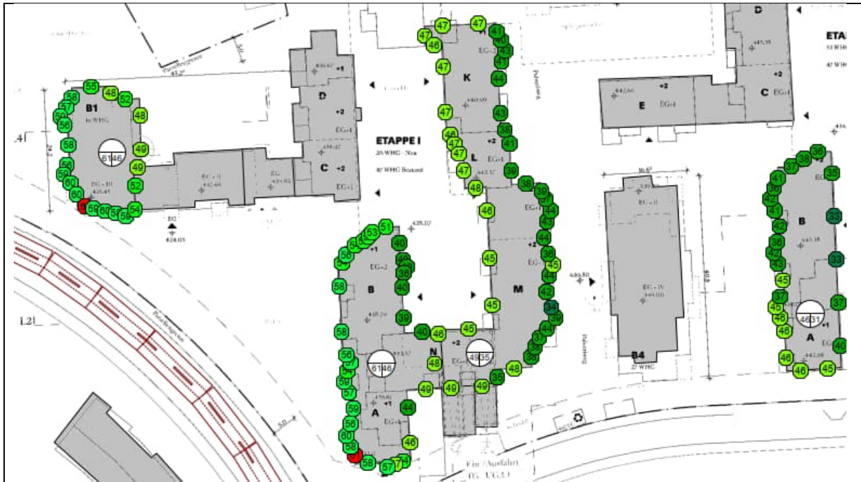
Maximale Strassenlärmbelastung am Tag
